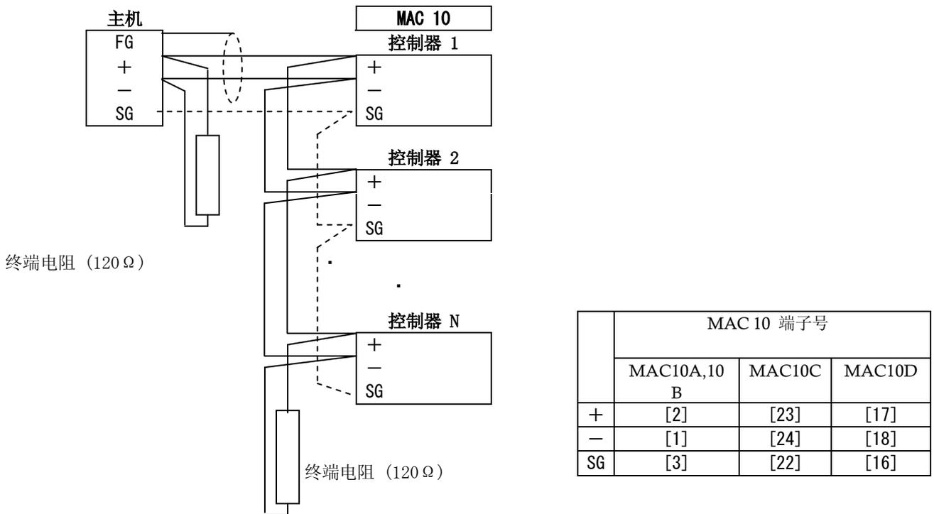
注 1: 工作时，在主机端和设备终端(+ 和 - 之间)分别安装 1/2W 120 Ω 终端电阻。
