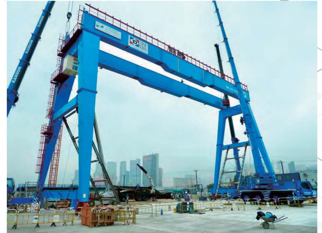
● 150噸門型吊車 150T Gantry Crane
