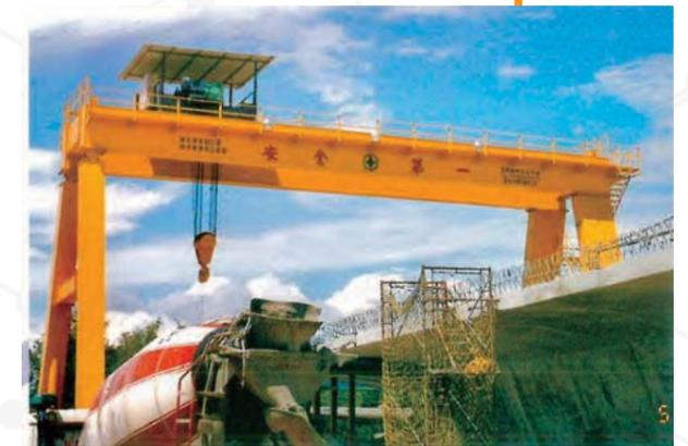
● 80T 門型吊車 80T Gantry Crane
