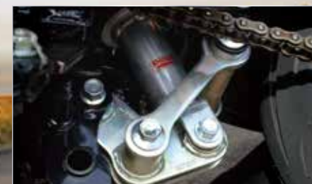
SHOWA中置多連桿懸吊系統
