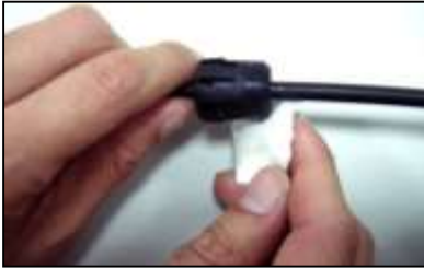
以酒精清潔光纖及橡膠斷面
