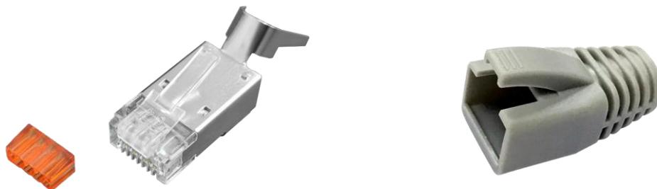
Category6A RJ45 8P8C Shielded plug適用於全遮蔽式22~24AWG雙絞線，零故障品質，超越ANSI/EIA/TIA 568-B.2-1；ISO/IEC 11801的接頭規範。在任何網路環境下，提供極穩定、超高速的傳輸品質。其獨特全遮蔽式零件，可有效降低線對之間串音干擾，保持產品的穩定性，並提高超高速傳輸品質。
